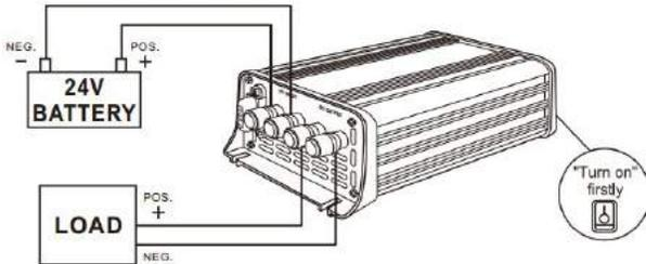
(B) Wenn Sie ein elektrisches Gerät an den Spannungswandler anschließen, versichern Sie sich, dass die Nennleistung des Geräts die Nennleistung des Spannungswandlers nicht übersteigt.
