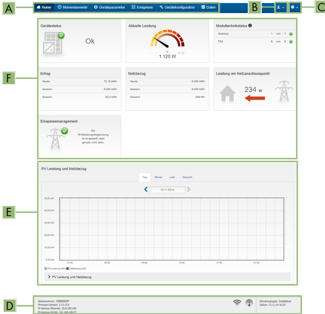
Abbildung 14: Aufbau der Startseite der Benutzeroberfläche (Beispiel)
