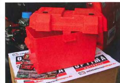
Die Batterie muss sicher verbaut werden. Dazu kann man spezielle Halterungen oder so einen Batteriekasten nehmen.
