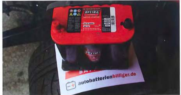
Ein Blick von oben zeigt die beiden Pole. Die RedTop gibt es auch mit vertauschten Polen und mit zusätzlichen Polen an der Seite. Bitte prüft genau, wie ihr sie braucht.
