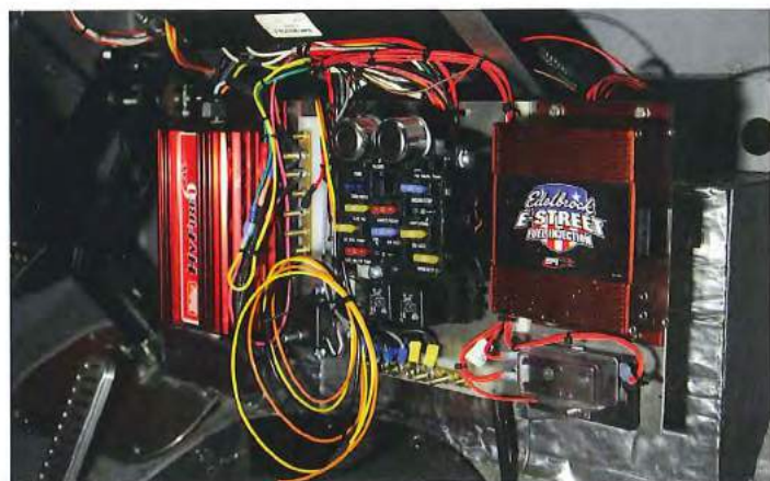
Ein Blick auf die elektrische Steuerzentrale des Street F100. Links die Mallory-HyFire-6AL-Zündbox mit Drehzahlbegrenzer, in der Mitte der Sicherungskasten von Painless Performance und rechts der noch nicht angeschlossene Computer der Edelbrock-Einspritzanlage, die wir am 347er Ford im Street F100 mal ausprobieren wollen.
