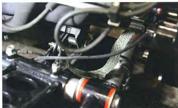
Das Masseband des Motors im Street F100 haben wir mit dem Hauptmassekabel von der Batterie kommend verbunden. Da der Anlasser der mit Abstand größte (wenn auch nur kurzzeitige) Stromfresser im Kfz ist, muss man hier auf die entsprechenden Kabelquerschnitte achten.
